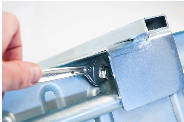
**Inserire la guida del fusto nell'apposita asola con le alette rivolte verso l'esterno.**
