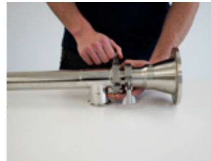
Clamp am Pumpenrohr öffnen
