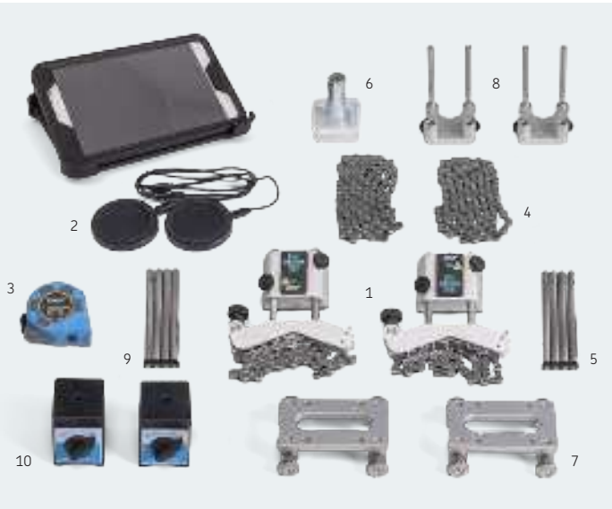
Messgerät: (1) Messeinheiten (M & S) mit serienmäßigem V-Winkel, (2) kabellosen Ladegehäusen mit USB-Anschluss und (3) Maßband Standardzubehör: (4) Verlängerungsketten, (5) Verlängerungsstangen und (6) Montagemagneten Zusatzzubehör: (7) Schiebekonsolen, (8) Versatzrahmen, (9) zusätzliche Verlängerungsstangen und (10) Magnetfüße
